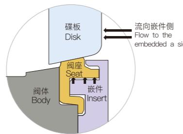
当压力施加于非嵌件的一侧时，蝶板被推向阀座。由于蝶板的轮廓呈球形，蝶板越向阀座推进，关闭就越紧密。唇缘与嵌件底部的槽接触，限制了阀座的过量移动。
