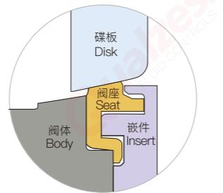
当嵌件侧受压时，压力被施加于唇缘的下方进一步加大了蝶板与阀座之间的密封力。
