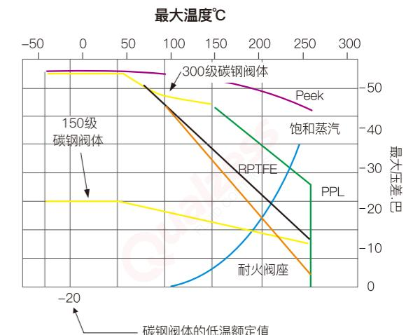
注意: 316不锈钢或20号合金阀杆的14"-80" (DN350-2000)的150级阀门的最大压力差为150psi 316不锈钢或20号合金阀门的3"-36" (DN80-1000)的300级阀门的最大压力差为300psi
